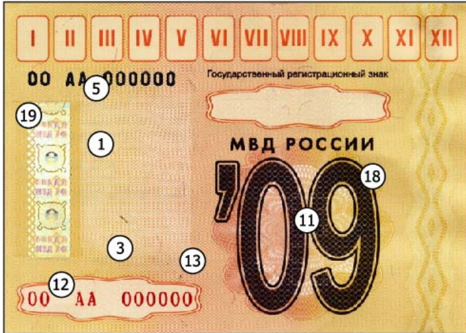
Видимая на просвет цифра 2009 из микроотверстий
